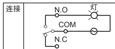
■ 外部开关输入的连接 (附加功能)
