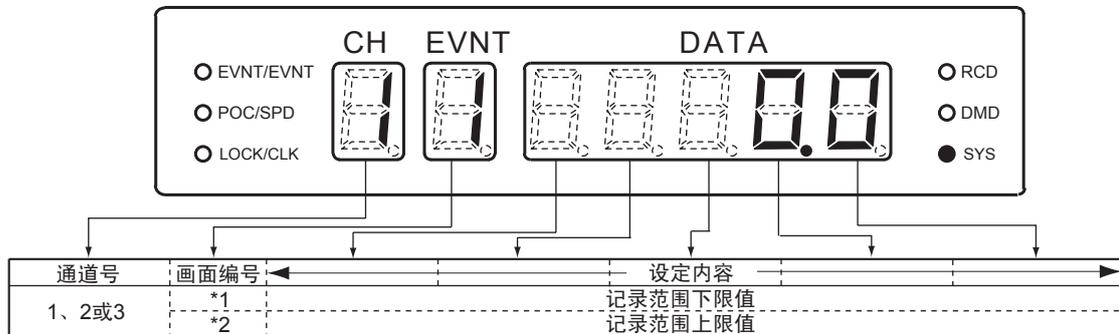
\*:量程代码改变时,与新量程代码对应,记录范围上下限值被初始化。(系统设定2的量程代码变化时,在系统设定3,与新的量程代码对应,记录范围上下限值被初始化)
