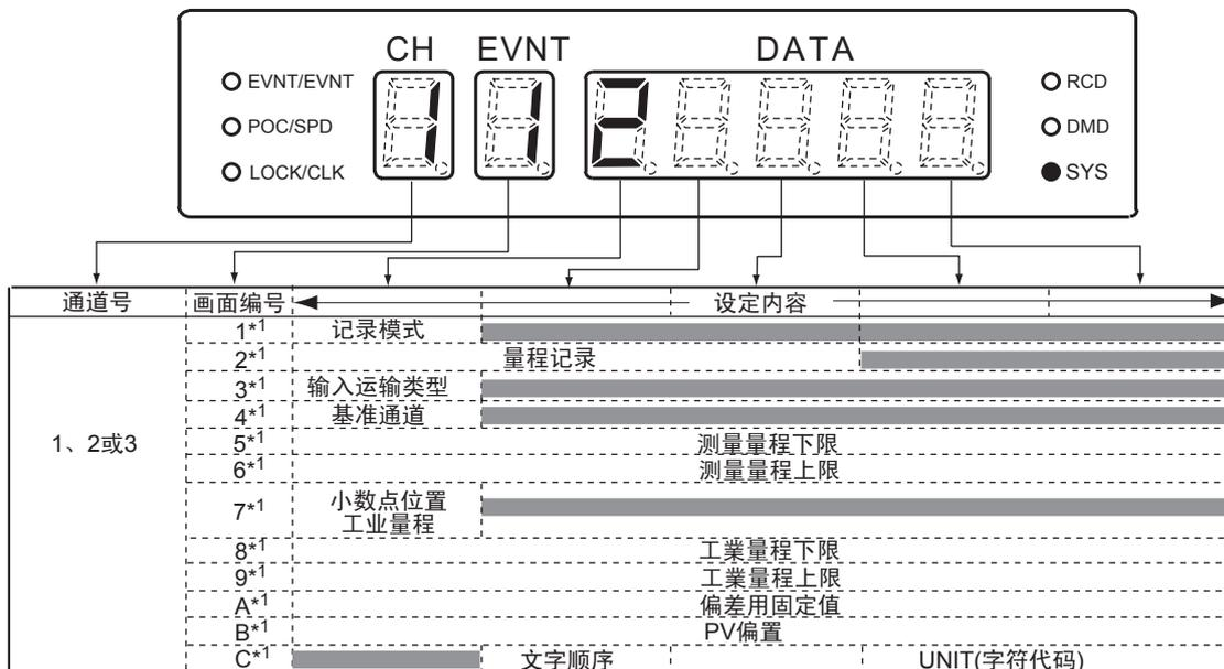
\*1: 量程代码改变时, 与新量程代码对应, 设定值被初始化。
