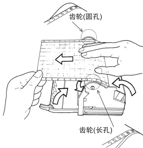
⑥ 用记录纸压板将记录纸的长孔安装在记录纸盒的突起部分的下面。
